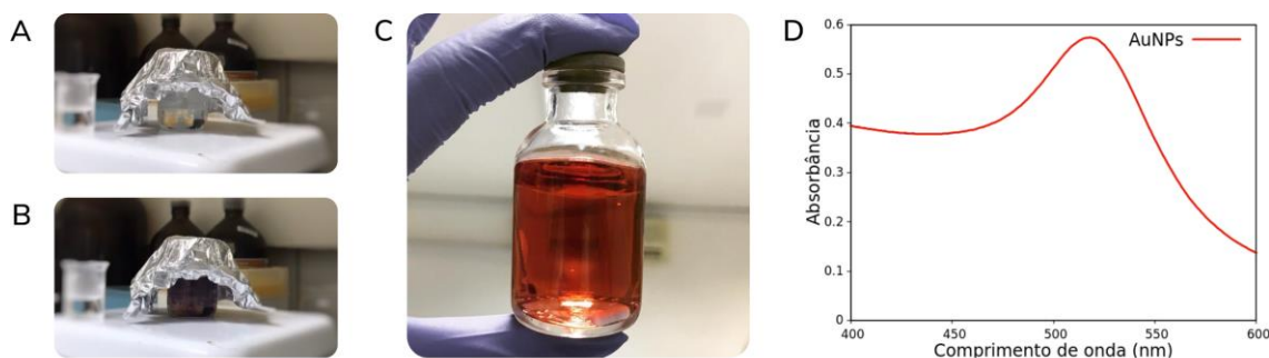
Figura 5 - A) Gradual transição de cor devido a redução dos íons de \text{Au}^{+3} a \text{Au}^0 . B) Crescimento das AuNPs. C) Solução final com coloração avermelhada, indicando estabilização das AuNPs. D) Espectro UV-Vis das AuNPs.
